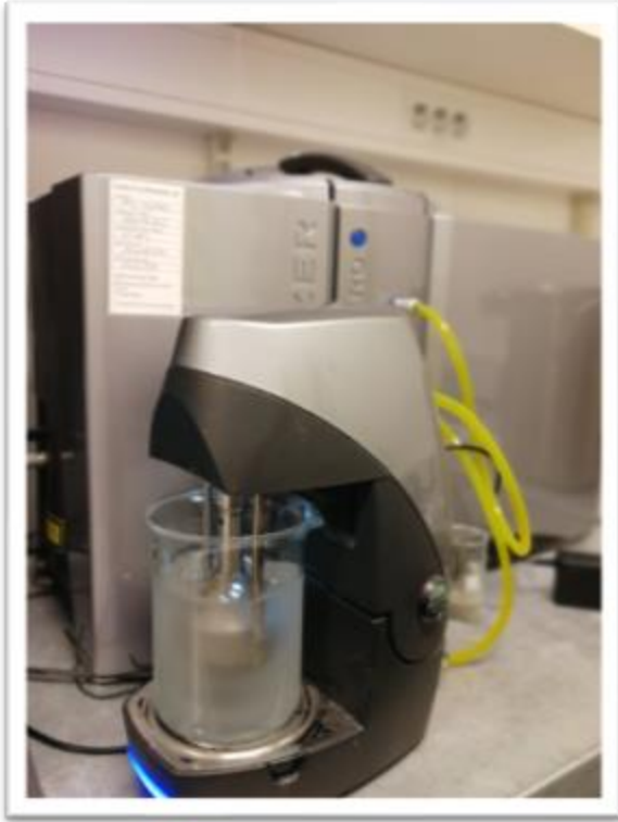
[Figur 6.6]: Bildet viser partikkel telleren Hydro EV under partikkel telling av en vannprøve. Apparatet er sammenkopleet med en datamaskin ved hjelp av programvaren Mastersizer 3000.
