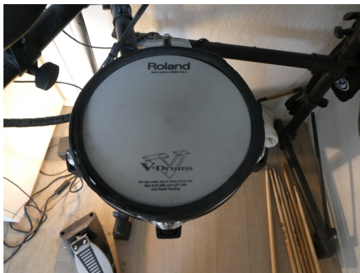
Illustrasjon 7: Elektronisk trommepad, Roland TD-3 uten elektronisk signal. Foto: Marius Trøan Hansen
