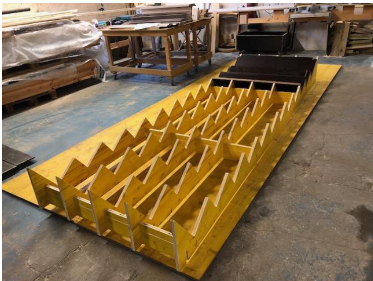
Figur 7-8: Trappeform utarbeidet av PERI, illustrasjon mottatt på mail.
