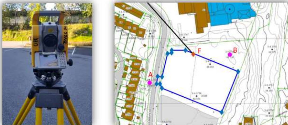
Figur 5.2 Totalstasjon og oppmåling av parkeringsplass v/UiA.
