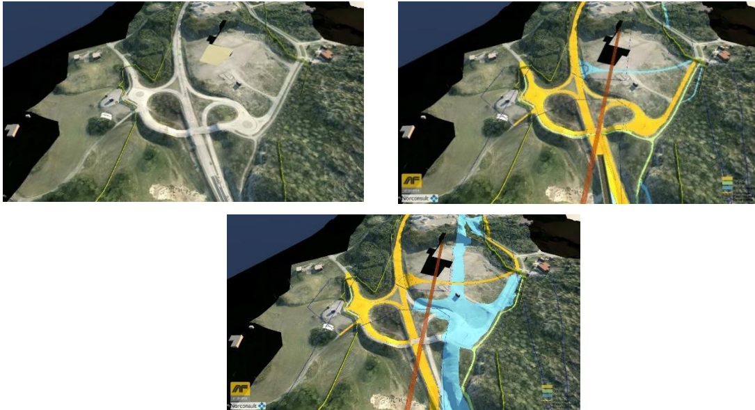
Figur 12 – De ulike fasene for trafikkavvikling i anleggsperioden. Fase 0 øverst til venstre, fase 1 øverst til høyre og fase 2 under (Norconsult & AF Gruppen, 2017)
