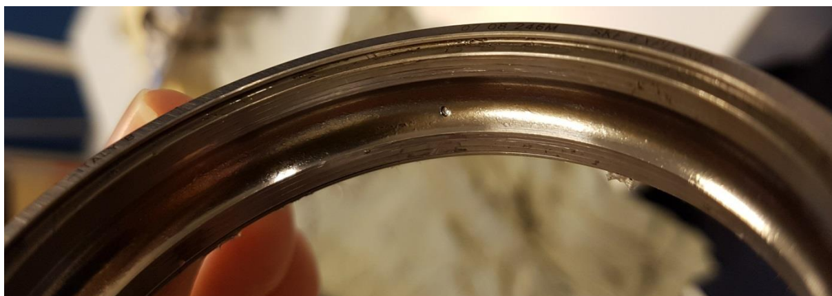
Figur 36 Skadet ytter ring fra testlageret SKF6008
