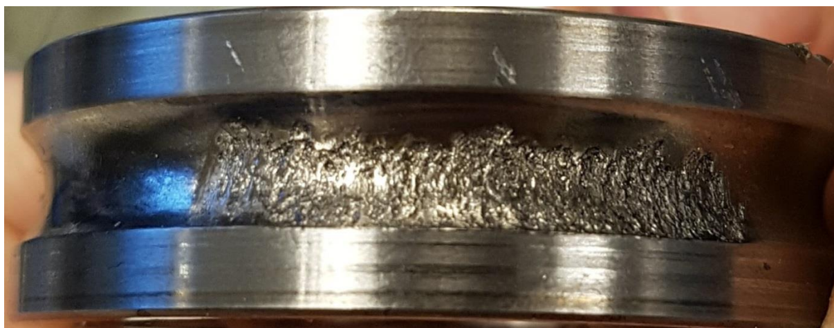
Figur 39 Skadet inner ring fra testlageret SKF6008
