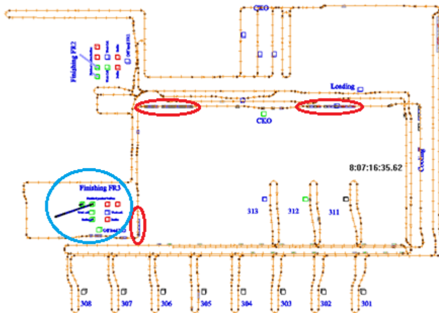
Figur 17. Viser simulering med FAC sine opprinnelige produksjonsdata der de røde sirklene viser kødannelse og den turkise sirkelen viser bruk av én finishingcelle for F01.
