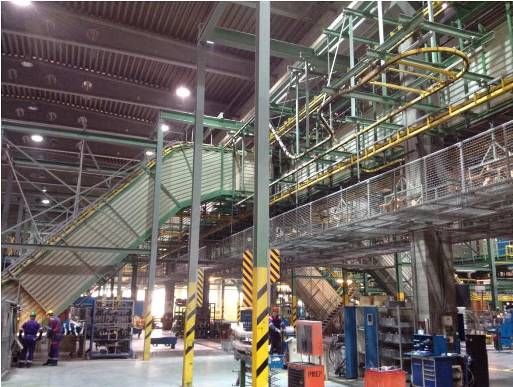
Bilde 2. Viser støpemaskinen og hvordan den er tilknyttet hengebanen. Punkt 2. på oversiktsbildet.
