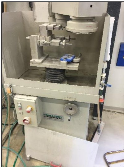
Figur 5-32 Maskin for sliping av prøvelegemer
