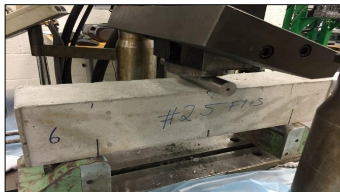
Figur 5-35 Bjelke for testing av momentkapasitet og bøyestrekfasthet
