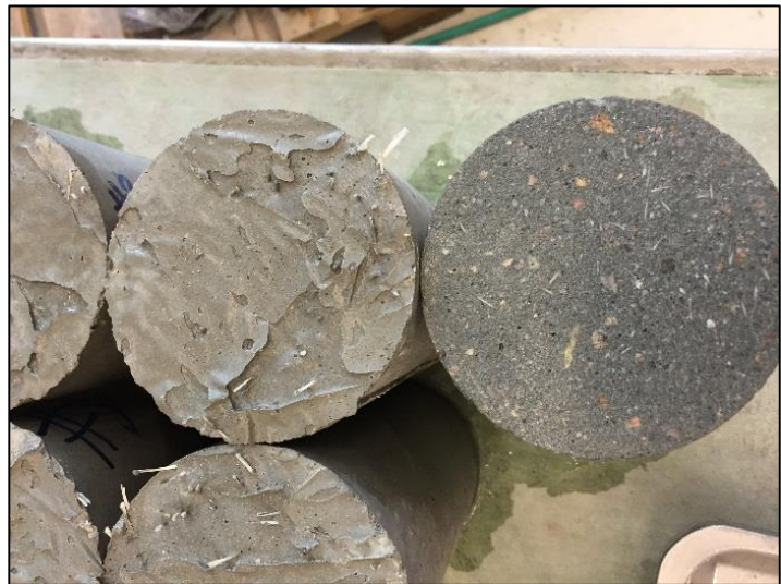
Figur 5-31 Prøvelegeme før og etter sliping
