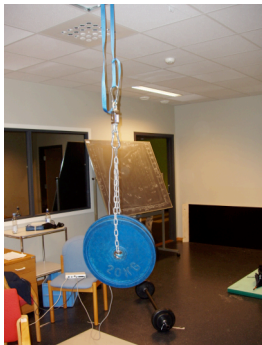
Bilde 3: Kalibrering av load cell.
