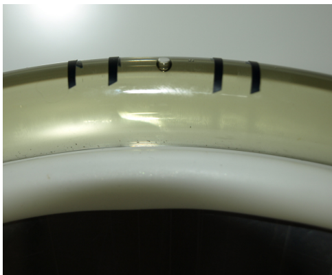
Figur 17: Nærbilde av GP-vateret som viser bestått sonen (innerste markering) og korrekt utgangsposisjon for vateret.
