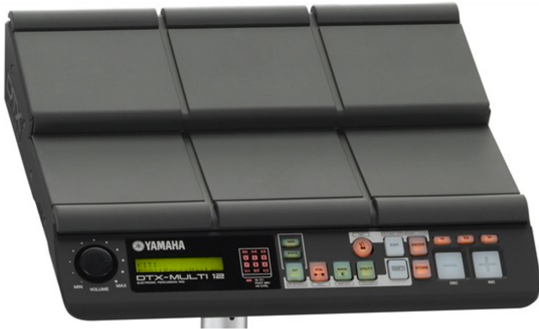
Figur 4.5 Yamaha DTX multi 12. Lydmodul med 12 integrerte pads og sampler. (Rettigheter for bruk av bilde klarert med rettighetshaveren)
