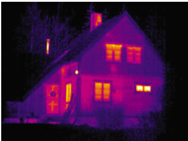
Figur 3.17: Termogram av en enebolig
