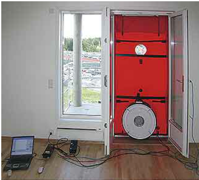
Figur 3.18: Testing av tetthet ved trykkmetoden
