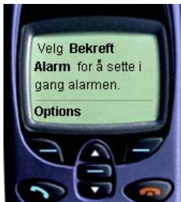
Figur 26: Displayet i WAP-telefonen forteller pasienten hva som må gjøres for å sette i gang alarmen
