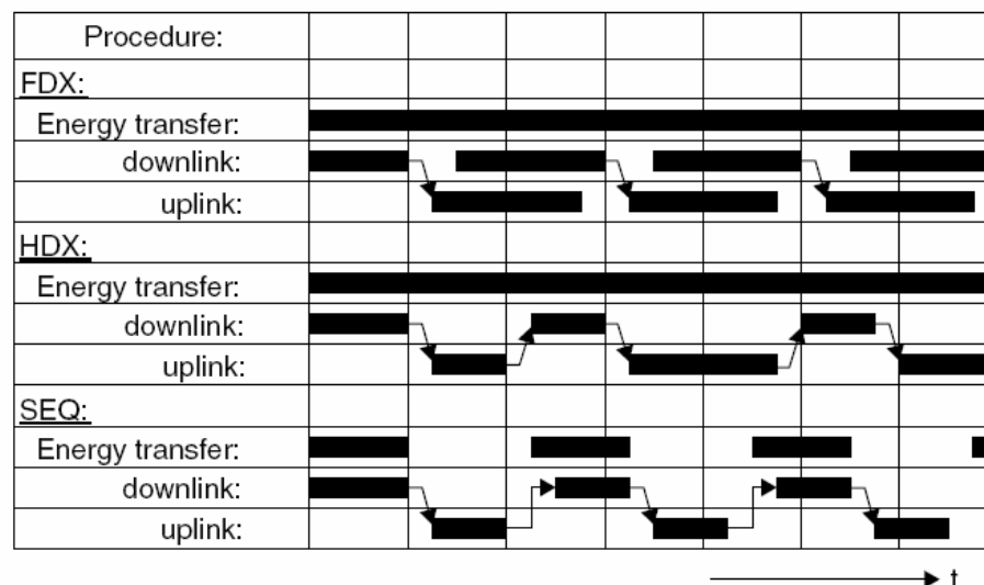
Figur 2-5 Energi- og datautveksling i FDX-, HDX- og SEQ-systemer over tid. [6]
