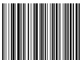
Figur 22 Teksten "Logit D2D" kodet med Code-128 (Alphanumeric) [34]
