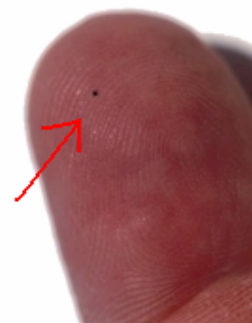
Figur 31 RFID-brikke fra Smartcode Corp
