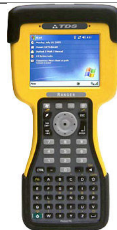
Figur 15 TDS Ranger: Eksempel på enhet hvor fysisk tastatur opptar mye plass. Dette går også utover størrelse på skjerm.
