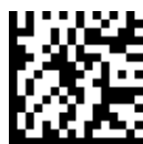
Figur 24 Teksten "Logit D2D" kodet med Datamatrix (alphanumeric) [34]
